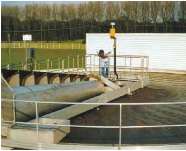
SDC 49 - Làm đặc bùn sinh học trong xử lý nước thải đô thị
